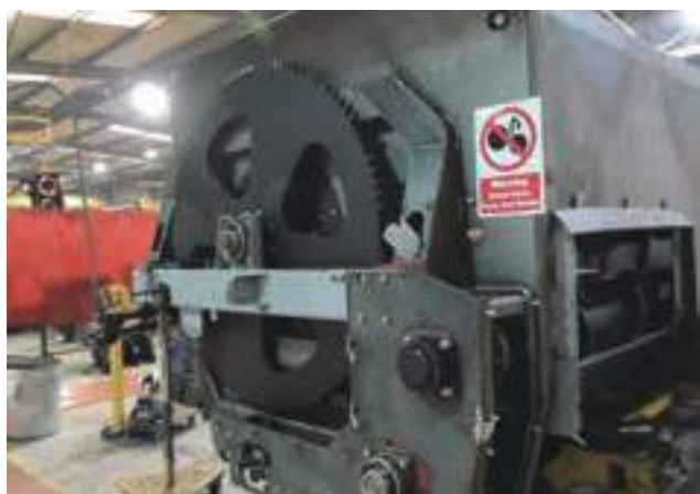
組み立て中のTMRミキサー
