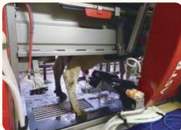
搾乳ロボット内で牛にティートカップが装着されたところ
