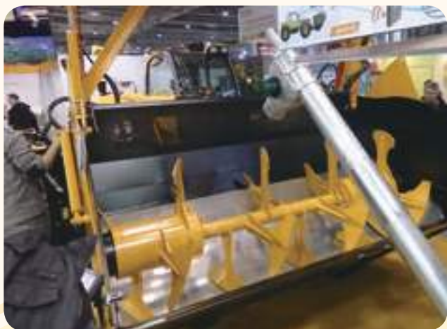
EMILY 社のミキサー。バケット部がミキサーになっており、少しでも省力化を目指していることが分かる
