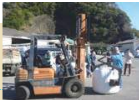
稼働中のベールクランプ
