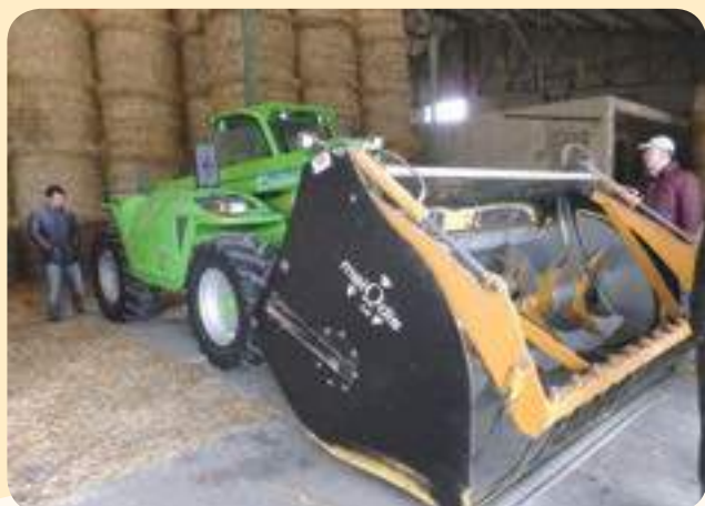
EMILY社製のMELODIS mélangeur 50。バケット部分がミキサーになっており、PMRやTMRがバケット側面から排出される(EMILY社のWebサイトwww.emily.frを参照)
