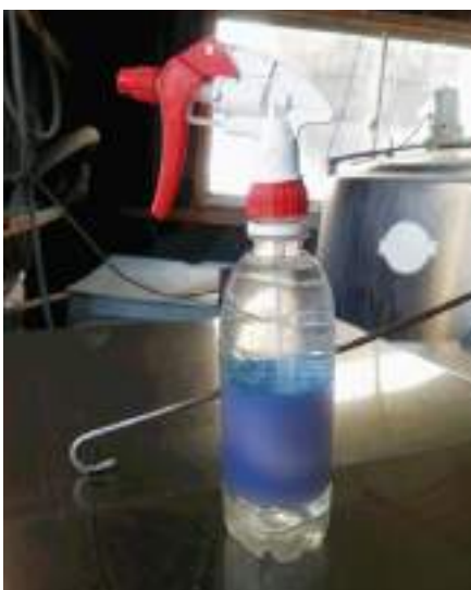
図1 | ペットボトルを利用したスプレーガン
